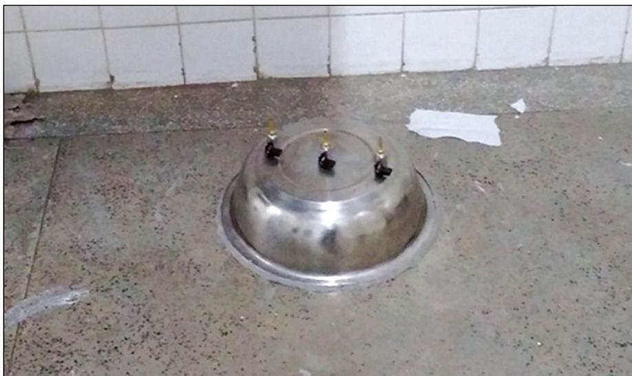
Figura 4. Câmara de confinamento para teste qualitativo. Fonte: Elaborada pelo autor (2024)
