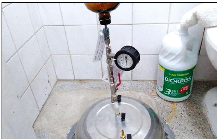
Figura 14. Amostragem TO-15 Câmaras de Fluxo na Edificação 1 próximo ao ralo 1. Fonte: Elaborada pelo autor (2024)
