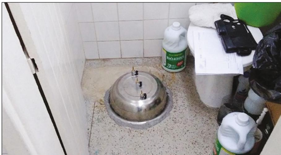
Figura 13. Câmaras de Fluxo na Edificação 1 próximo ao ralo 1. Fonte: Elaborada pelo autor (2024)
